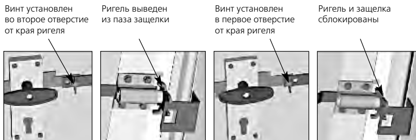
Рис. 4. Разблокированное и заблокированное положения защелки и ригеля
