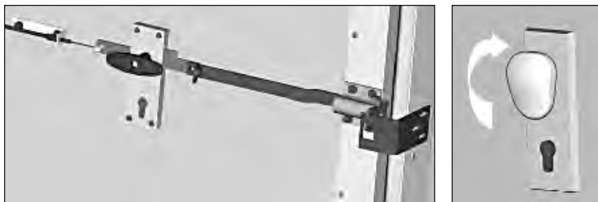
Рис. 6. Разблокировка электропривода снаружи помещения
